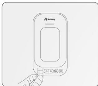
1. Inserisci il chip per la calibrazione
